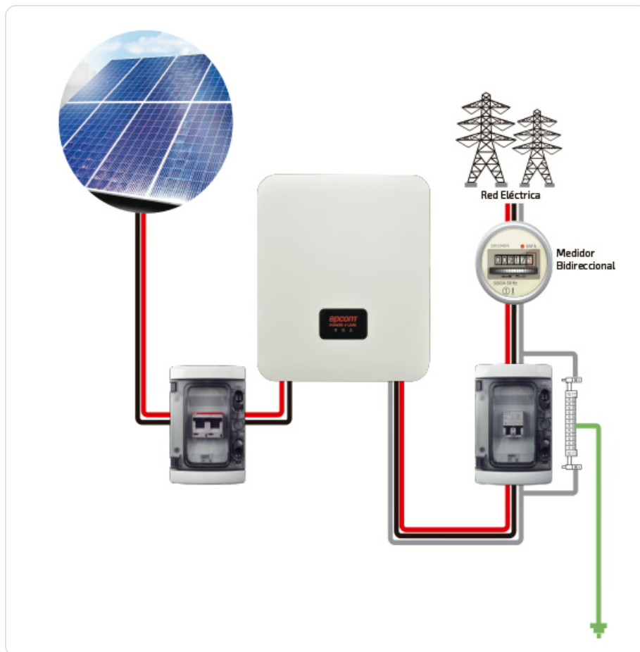
Diagrama de Conexión para Solución con Inversores de Cadena
